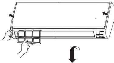
3. Для чистки фильтра используйте пылесос или промойте фильтр под водой, после чего просушите его.
